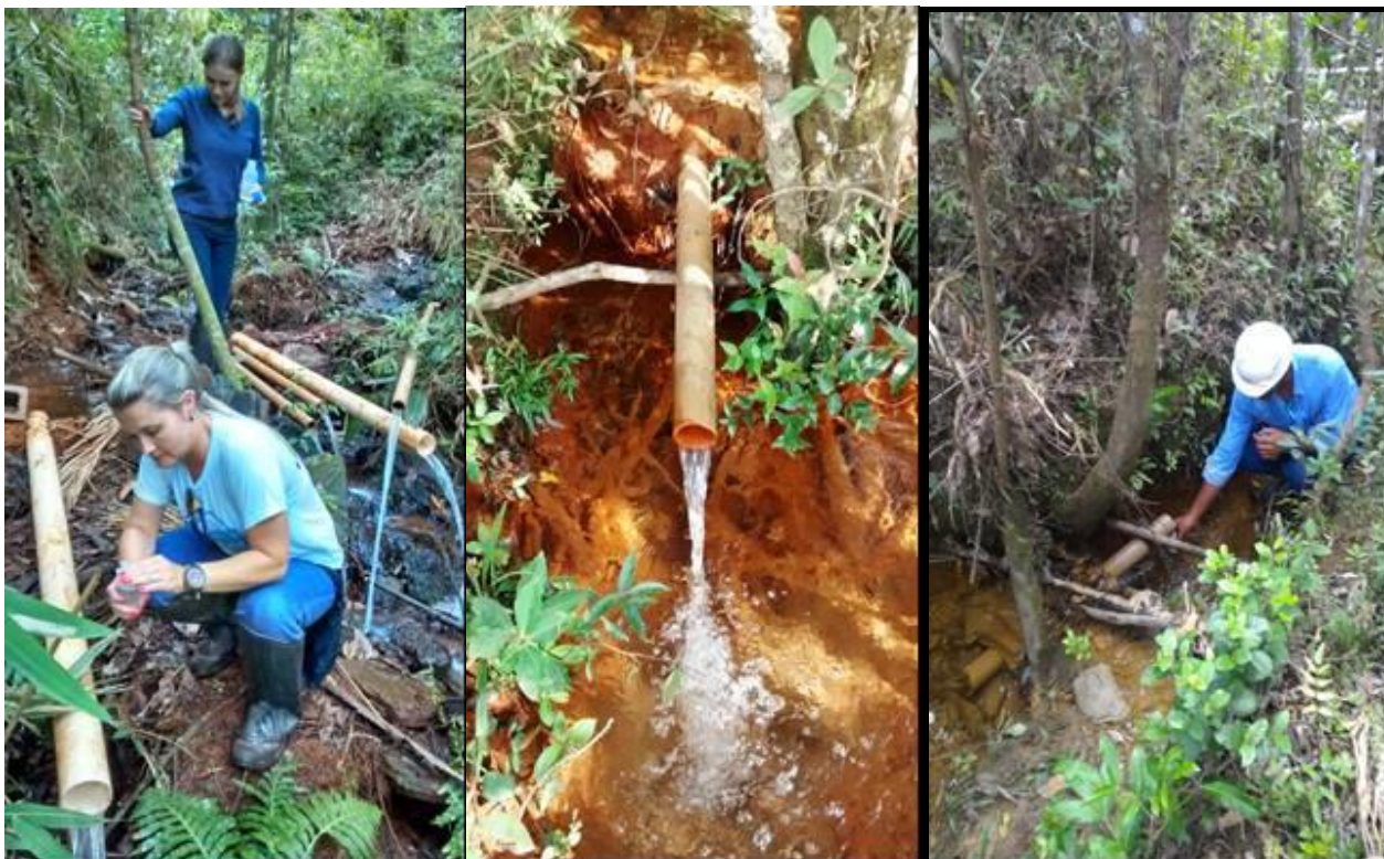
Figura 9 – Atividade de coleta de amostra e medição de vazão de nascente.
