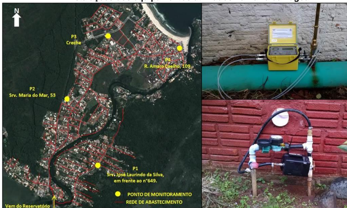
Figura 2: Localização dos pontos de monitoramento de pressão na rede e detalhe das instalações dos equipamentos utilizados na Barra da Lagoa
