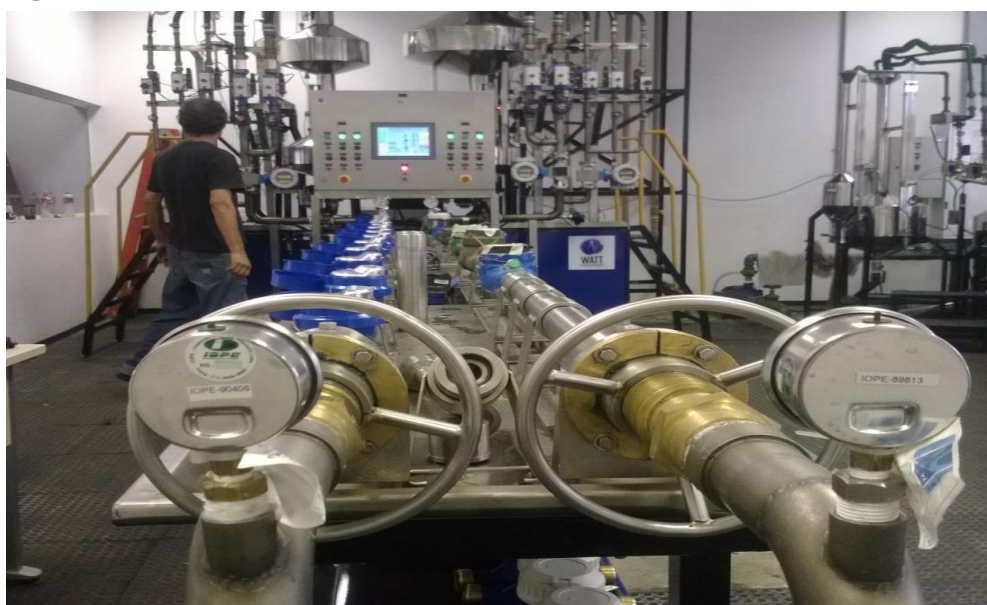
Figura 2: Bancada de ensaio de micro medidores Fonte: Acervo do autor
