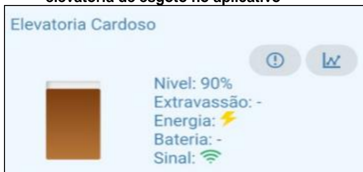
Figura 2 – Visualização da representação de uma elevatória de esgoto no aplicativo
