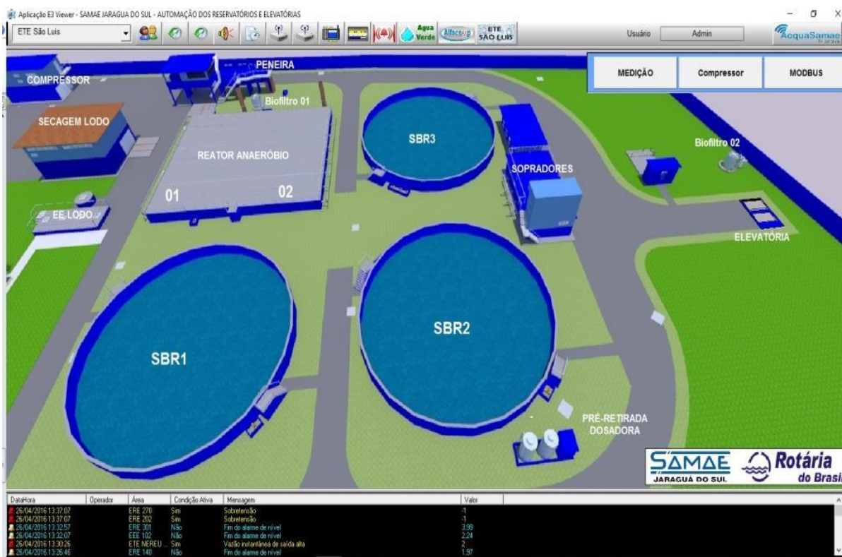
Figura 5 – Tela do sistema do monitoramento de uma Estação de Tratamento de Esgoto
